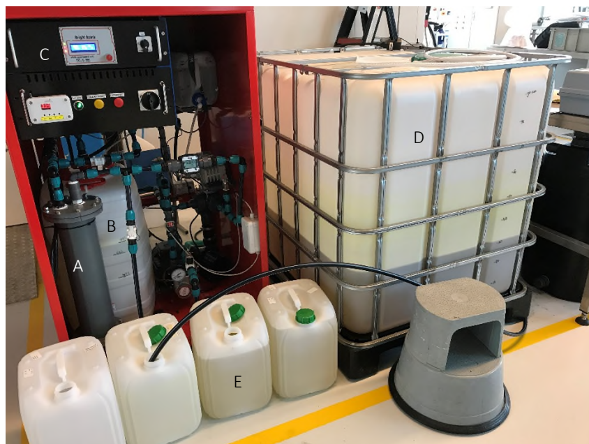
Figuur 6-1: elektrolyse opstelling. A: behuizing voor elektrodes waarover gerecirculeerd wordt. B: 75L batch voor het experiment. Dit wordt gerecirculeerd over de elektrode. C: paneel met de actuele spanning en stroomsterkte. D: Verdund referentiewater. E: Afvoervaten van behandeld referentiewater.
