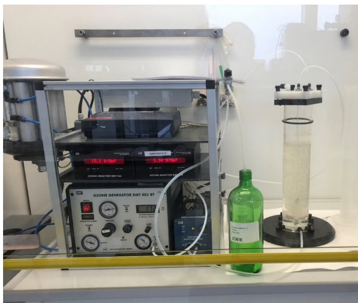
Figuur 5-1: ozoninstallatie voor lab-experimenten. Rechts de kolom met het water belucht met ozon.
